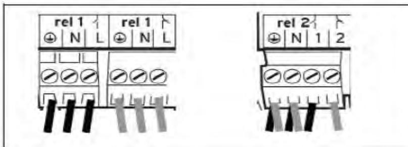
Подключение вытяжного колпака / клапана отходящих газов
