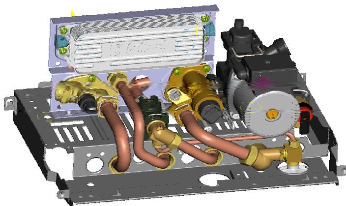
В верхней части гидроблока находится вторичный теплообменник, подключенный посредством фланцевых соединений, в нижней части расположены: датчик давления, приоритетный переключающий клапан с регулируемым байпасом и подключение насоса отопления
