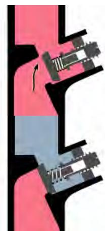
Подключение к новому гидравлическому блоку происходит посредством фланцевого соединения. Фланец серийно оснащен встроенным перепускным клапаном с ручной регулировкой.
