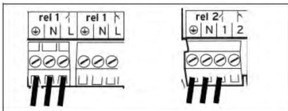
Подключение внешнего электромагнитного клапана
