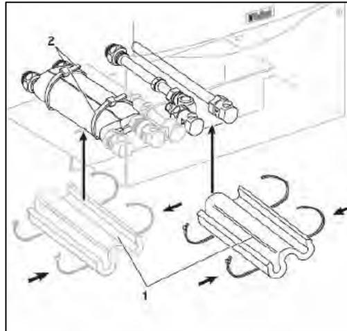
Рис. 5.4 Установка теплоизоляции
